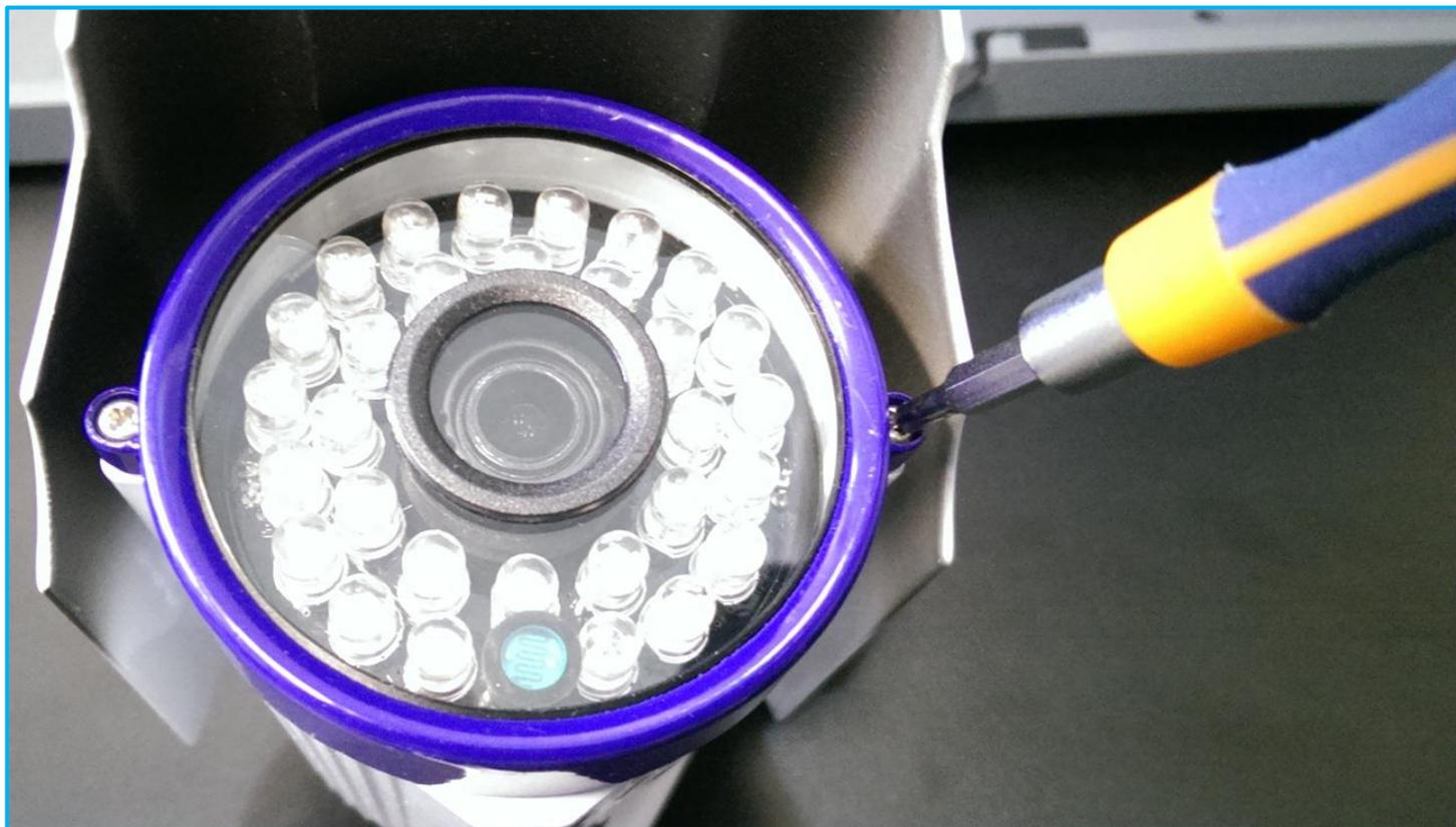
2. Проверните уплотнительную крышку в любую сторону, чтобы без особых усилий снять крышку.
