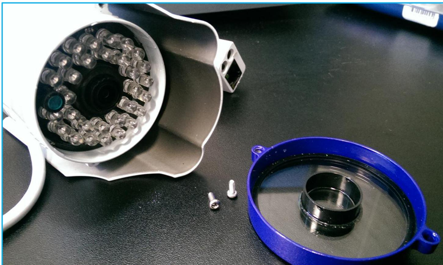
3. Снимите пороновою шайбу закрепленную на объективе. (Достаточно осторожно подцепить с нескольких сторон плоской отверткой).
